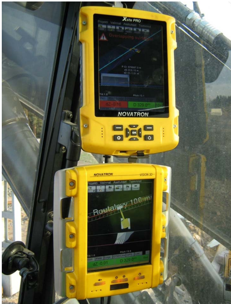
Kuva 4. Kaivukoneen ohjaamo, testiversio ylemmässä näytössä.
