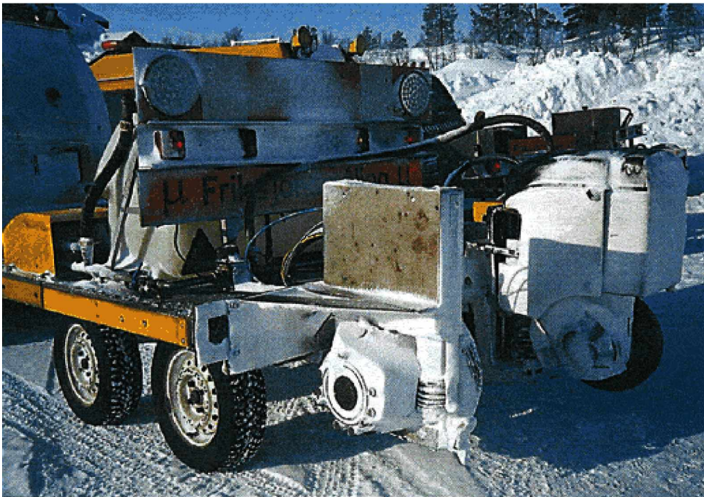
Kuva 14. ROAR-jatkuvatoiminen kitkanmittauslaite (Nonstad)
