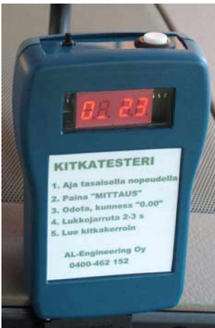
Kuva 4. Kiihtyvyyssanturilla varustettu Gripman-kitkamittari (Virtala 2008)
