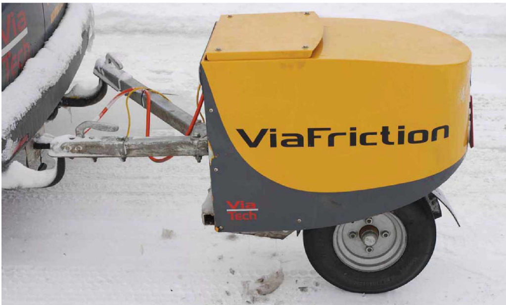
Kuva 12. Jatkuvatoiminen kitkamittari ViaFriction (Engström 2008)
