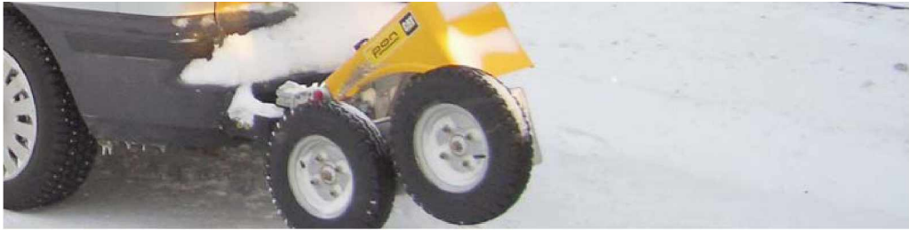
Kuva 11. Jatkuvatoiminen kitkamittari TWO (Engström 2008)
