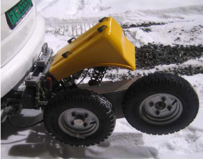
Kuva 3. Jatkuvatoiminen TWO-kitkamittari (Virtala 2008)
