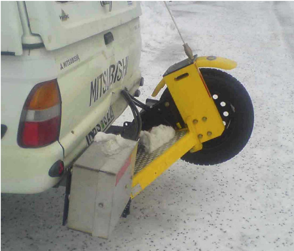
Kuva 10. Jatkuvatoiminen kitkamittari RT3 (Engström 2008)
