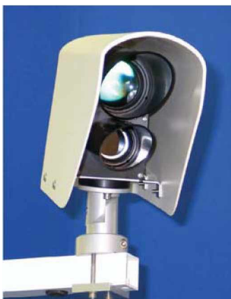
Kuva 1. Optinen kelianturi DSC111 (Vaisala Oyj)
