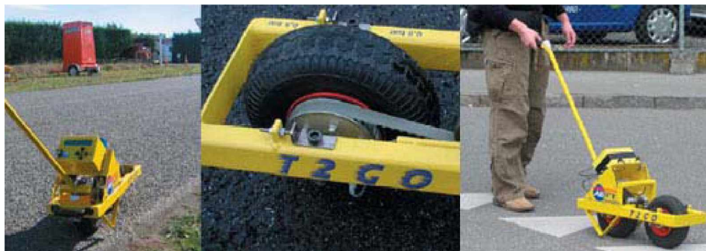
Kuva 23. T2 Go, ensisijaisesti lentokenttien kitkanmittaukseen tarkoitettu laite (ASFT)
