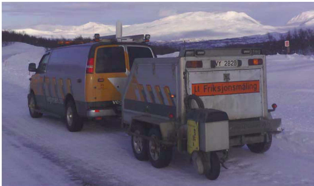
Kuva 22. Norjalaisten vertailutesti Roar:in ja DSC111:n välillä (Skrautvol 2009) Tutkimusraportin kuvatekstin mukaan DSC111 näkyy kuvassa valkoisena laatikkona pakettiauton katolla. DSC111:n suuntaus vaikuttaa hieman oudolta, ilmeisesti se on suunnattu vetoauton ja Roar:in väliin.
