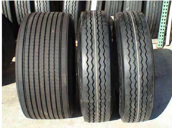
Kuva 11. Leveä yksikkörenkas eli niin sanottu super single -renkas koossa 445/50R22,5 sekä paripyörärenkaat koossa 275/80R22,5. (Priest ym. 2005, s. 4)
