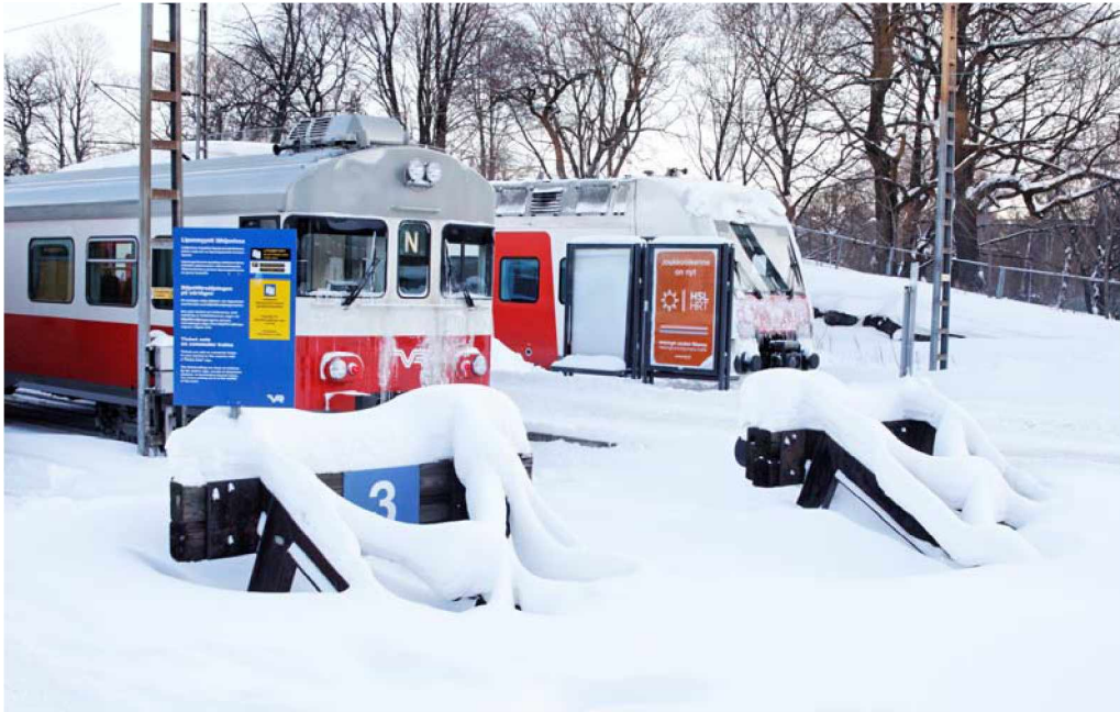
Kuva 18. Pölyävä jumi jäädytti junakalustoa siinä määrin, että sulatus- ja kuivatuskapasiteetti loppui kesken.
