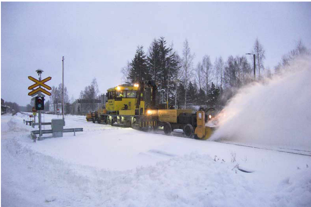
Kuva 15. Lumenpoistoa rata-autoon liitetyllä harjakoneella 29.12.2009 Rajamäellä.
