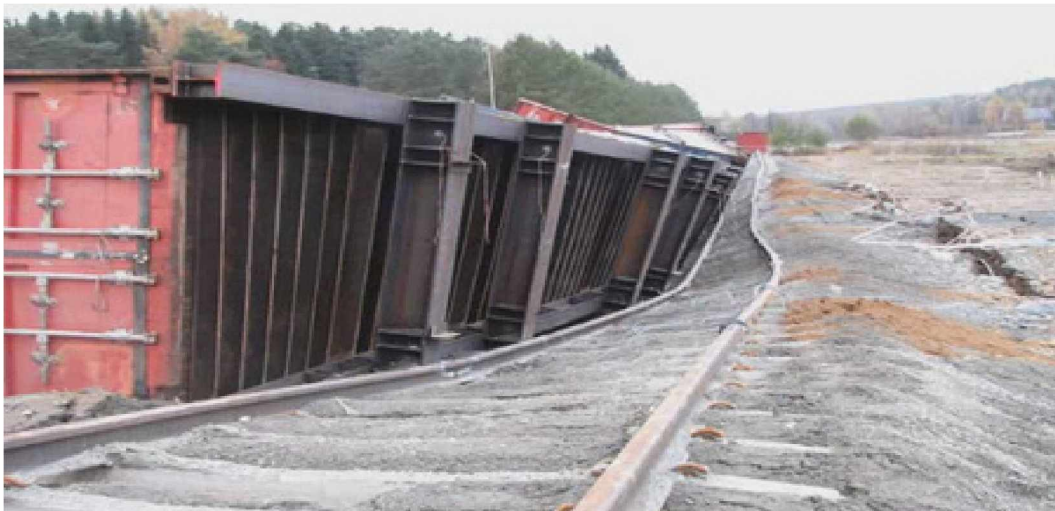
Kuva 18. Perniön sorrutuskoe. (Ratapenkereen stabiliteetti ja stabiliteetin parantaminen 2009)
