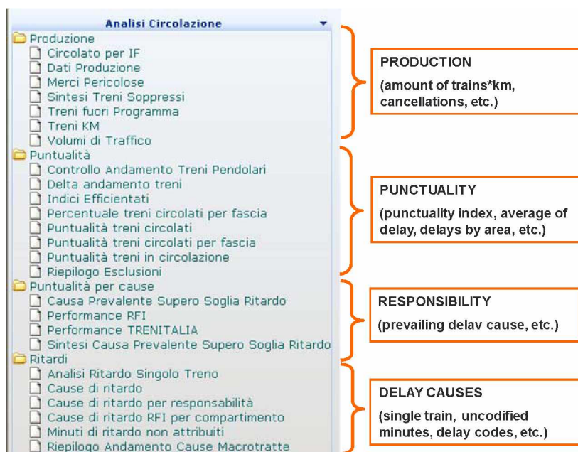
Kuva 7. Viiveiden analysointityökalun sisältämä tieto. (Torella 2009)
