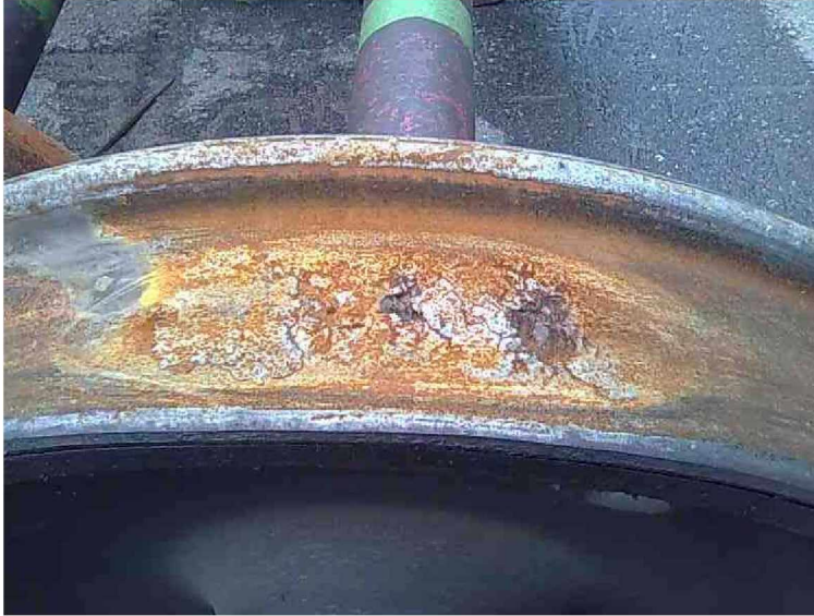
Kuva 30. Pyörän kulkupinnalla olevat rosot eli rakkalamuodostelmat ovat aiheuttaneet laakerivaurion.
