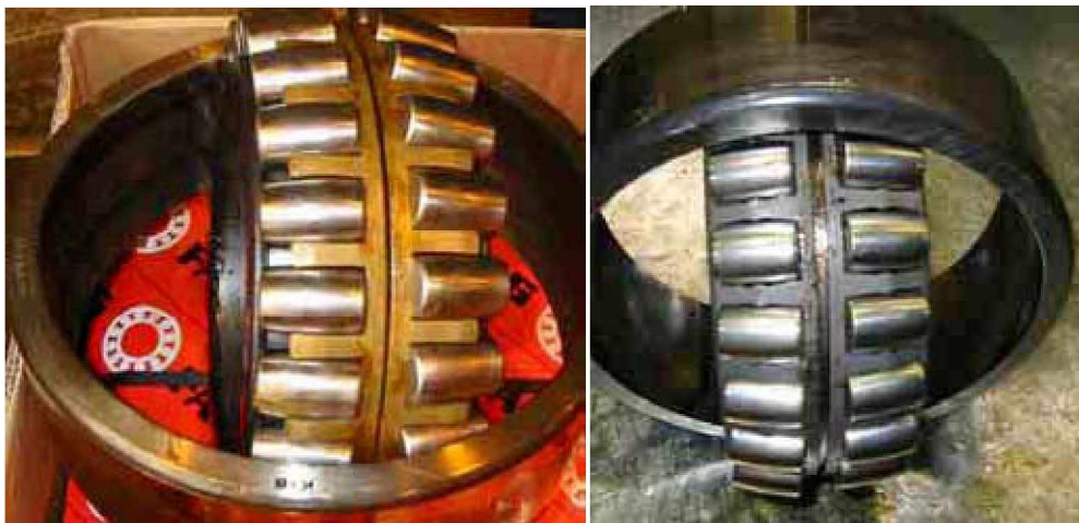
Kuva 35. Kaksi kaksirivistä pallomaista lieriörullalaakerit kampa- sekä ikkuna- pitimillä. /36/
