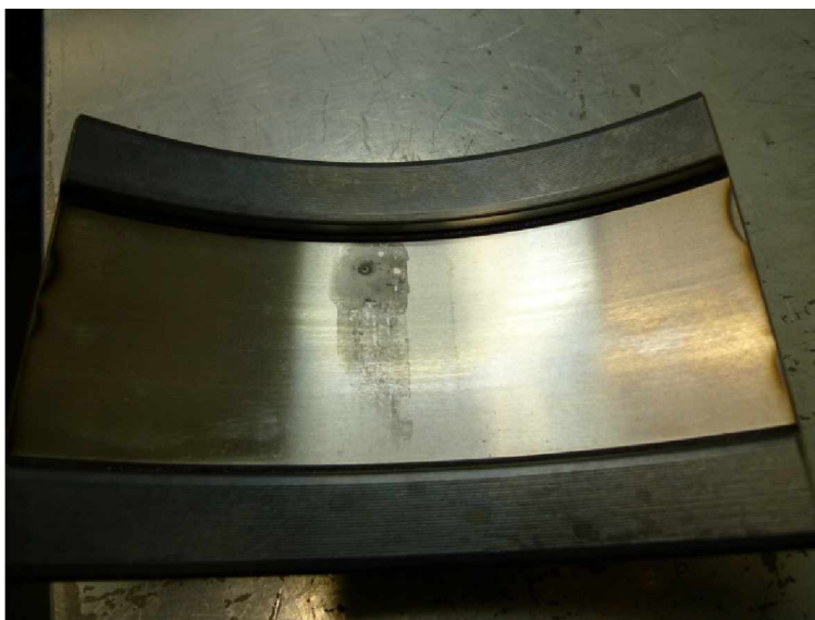
Kuva 33. Sähkövirran läpikulun aiheuttamat vauriot. /15/
