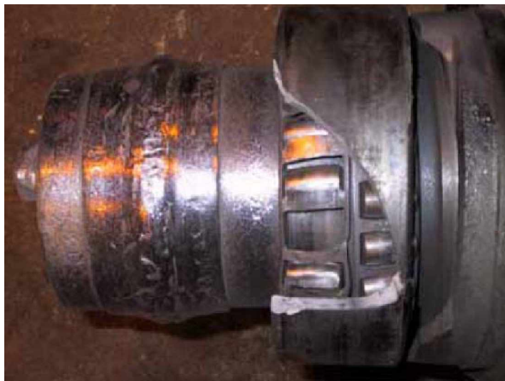
Kuva 32. Lovipyörästä aiheutunut laakerivaurio. /31/
