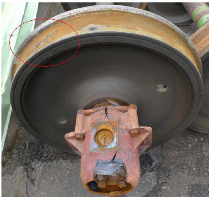
Kuva 29. Laakerivaurio joka on aiheutunut pyörän vierintäpinnalla olevasta lovesta.
