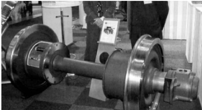
Kuva 15. RAFIL:n valmistama pyöräkerta jonka raidelevyettä voidaan muuttaa. /18/
