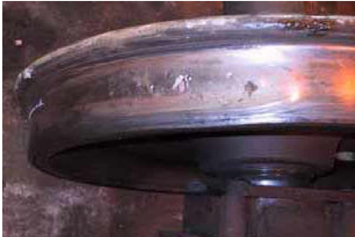
Kuva 31. Laakerivaurioon johtanut lovi pyörän vierintäpinnalla (loven pituus 310 mm). /31/
