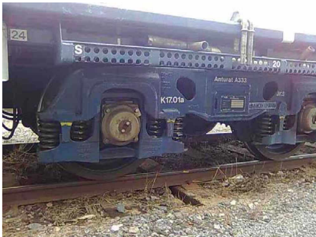
Kuva 8. VR:n omistama K17-teli (AM3-teli), jota käytetään muun muassa Sdggqss-w ja Sdggqss-w rekkavaunussa.
