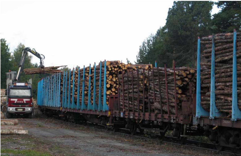
Kuva 5. Puun kuormausta junavaunuun kuorma-auton omalla kuormaimella (kuva: Metsäteho).
