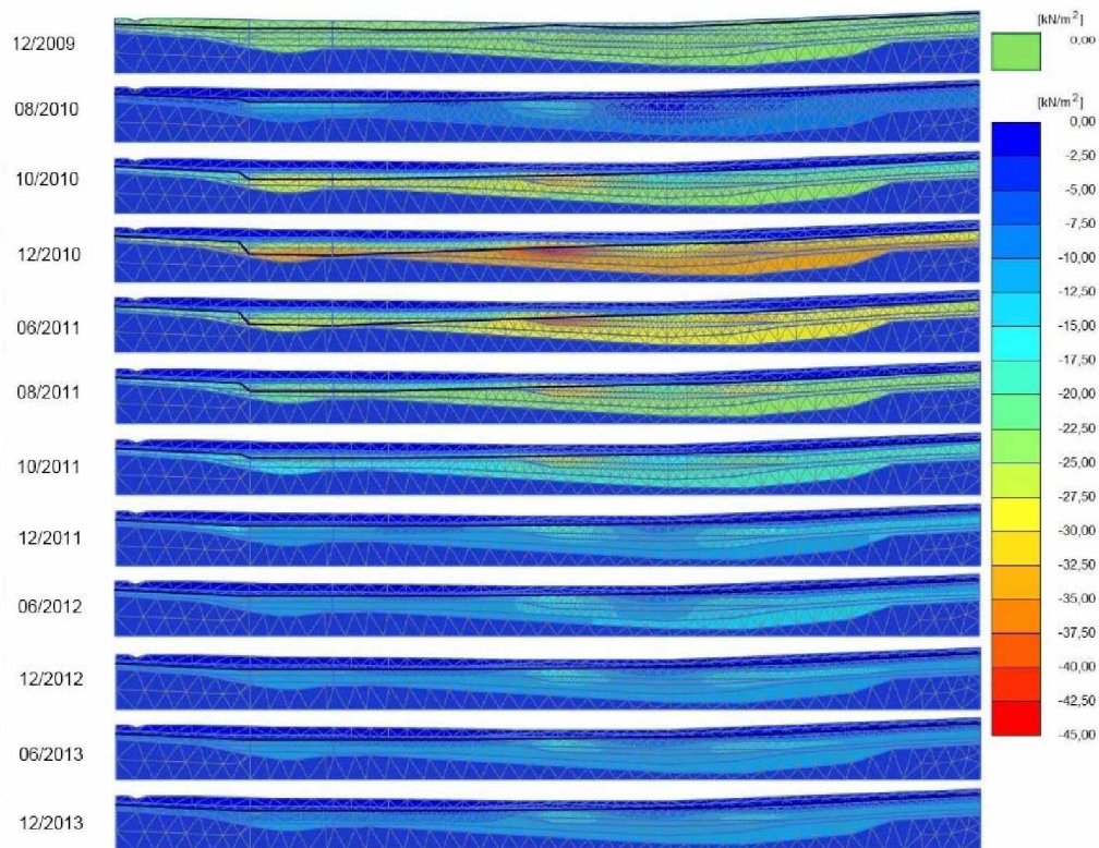
Kuva 44 Huokosveden ylipaineen kehittyminen pohjaveden muutosten seurauksena 2009–2013
