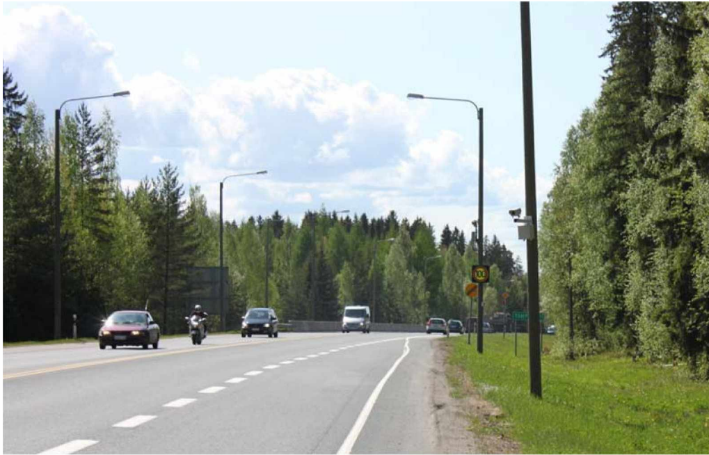
Kuva 5. VTT:n rekisteritunnuskamera valaisinpylväässä valtatie 9 ensimmäisessä mittauspisteessä ennen leveän keskialueen merkitsemistä.
