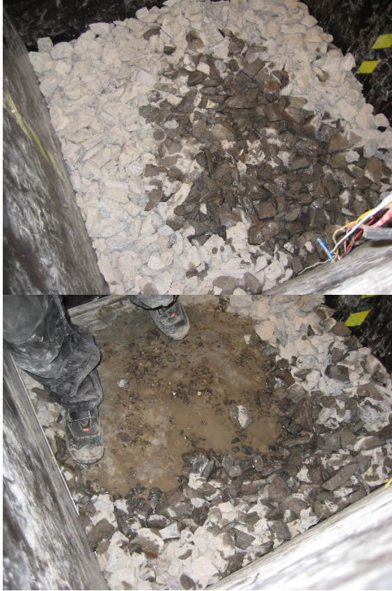
Kuva 5.5 Raidesepelinäytteen purku. Vasemmanpuoleinen kuva on noin 1/3 korkeudelta pohjasta lukien. Oikeanpuoleinen kuva on näytteen pohjalta. Näytteessä on selvästi havaittavissa kuivia kohtia, joissa vesihöyryä ei ole virrannut.
