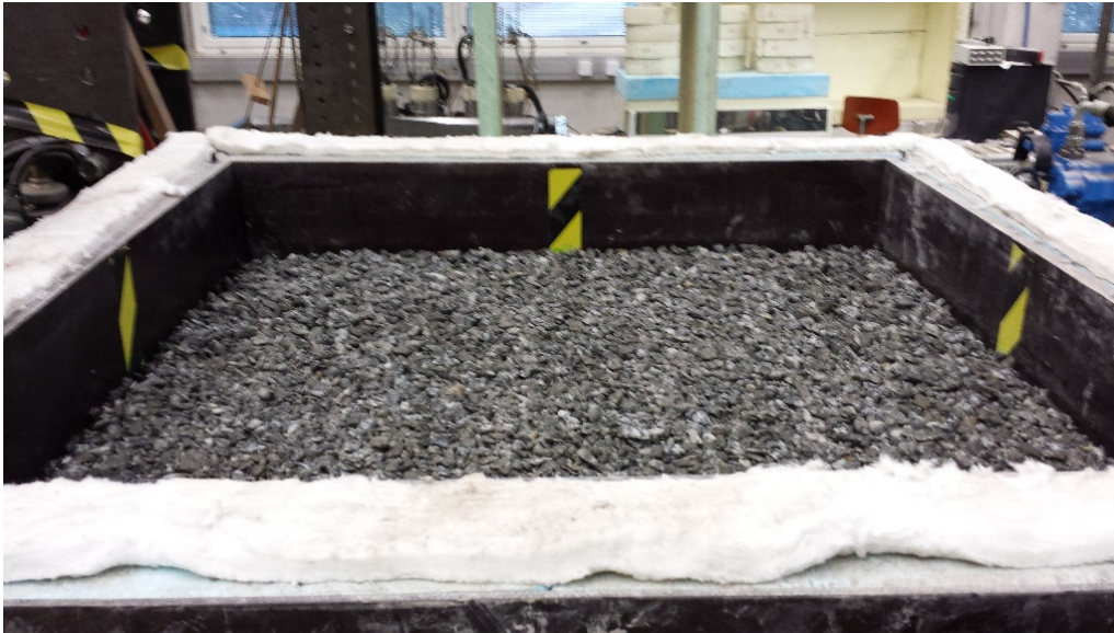
Kuva 5.13 Kalliomurskenäytteen kostea yläpinta testien jälkeen. Kun konvektiolaite avattiin, oli 5/16 mm näytteen yläpinta selvästi kostunut.
