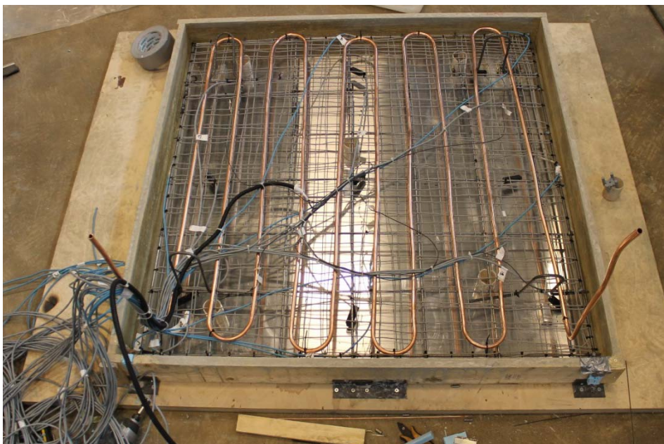
Kuva 4.13 Näytteen päällä oleva lämmönsiirtolaatta. Laatussa olevat rakenteet on kasattu alalaatan peilikuvana, ja ne ovat näytteen suhteen samoin päin. Ylälaatussa ei ole lämpövoantureita. Myös johdot ja kupariputket lähtevät ylöspäin, jotta laatta voi vapaasti kellua näytteen päällä.
