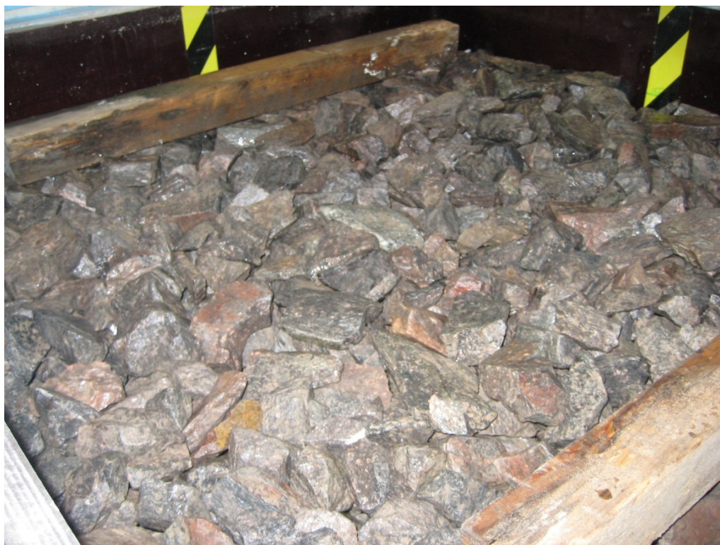
Kuva 4.21 Raideseppelinäyte testiajojen jälkeen. Kuvassa näkyvien puukapuloiden avulla ylälämmityslaatta nostettiin irti näytteestä. Näyte on kastunut kostean tilan testauksessa ylhäälle saakka.
