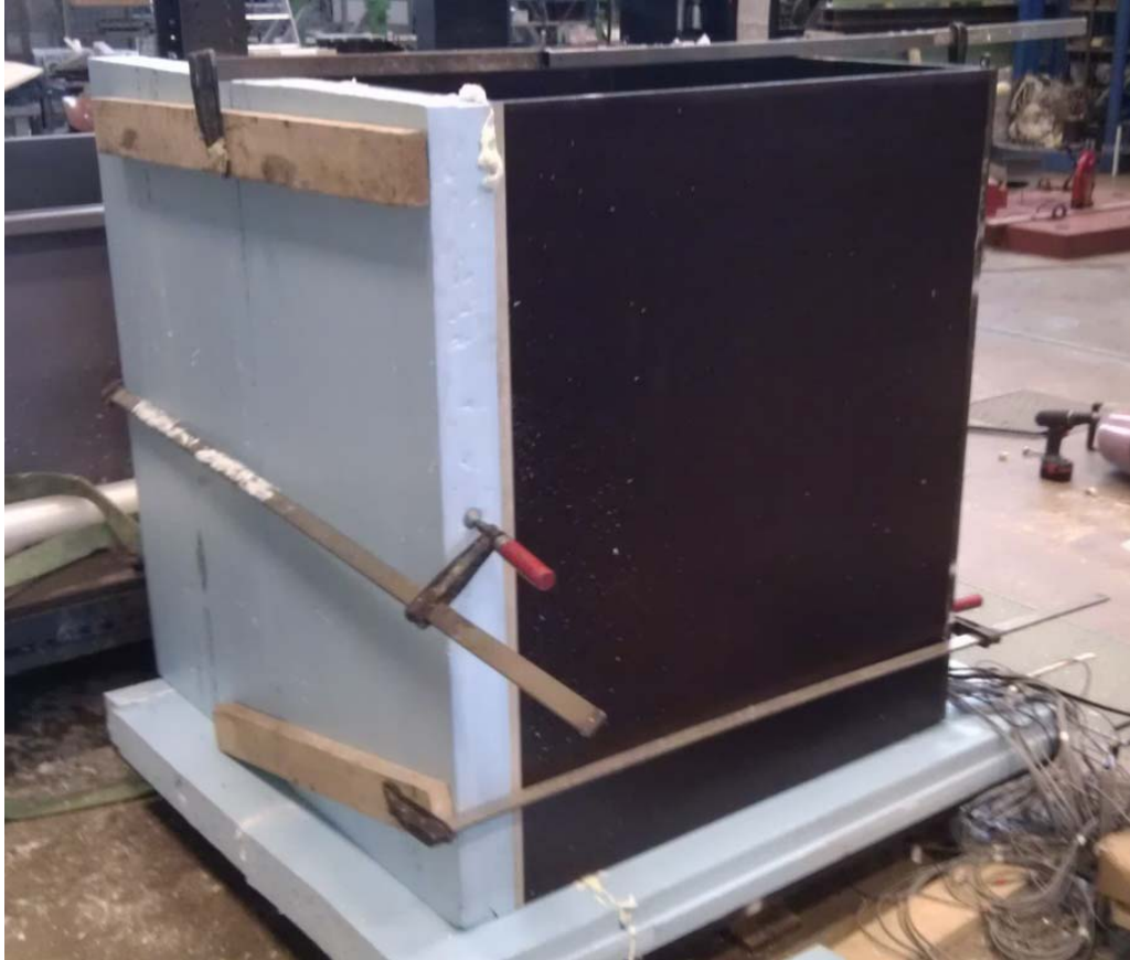
Kuva 4.5. Näytetilan eristäminen 100 mm XPS-eristeellä. Eristeet on liimattu kiinni filmivanerin pintaan ja raot on tukittu uretaanivaahdolla.
