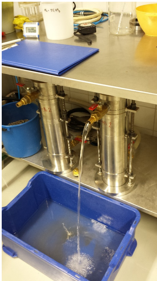
Kuva 4.27 Vedenläpäisevyysskoe käynnissä 5/16mm kalliomurskeelle. Jo 10 mm painekorkeudella vettä tuli todella paljon läpi.
