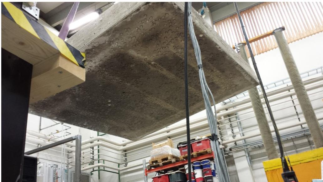
Kuva 5.12 Ylälaattaan tiivistyneet vesipisarot. Ylälaatan alapinnassa oli selvästi nähtävissä tiivistyneitä vesipisaroita purettaessa 5/16 mm kalliomurskenäytettä.
