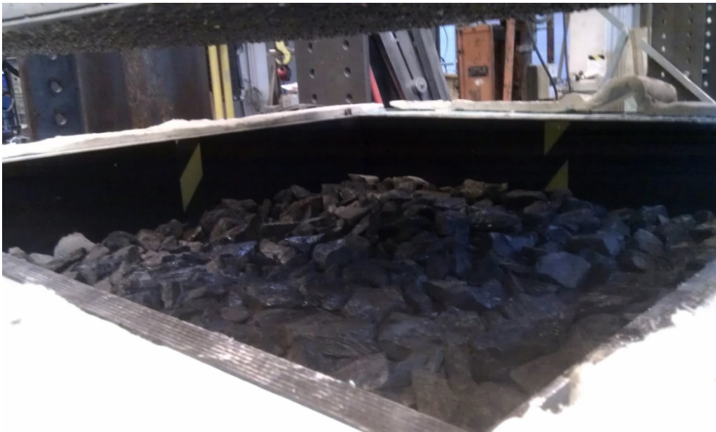
Kuva 5.4 Raidesepelinäyte kostean tilan konvektiokokeen jälkeen. Kun laatikko avattiin, näyte oli selkeästi kastunut ylhäälle saakka ja ylälaatan alapinnassa oli runsaasti tiivistyneitä vesipisaroita.
