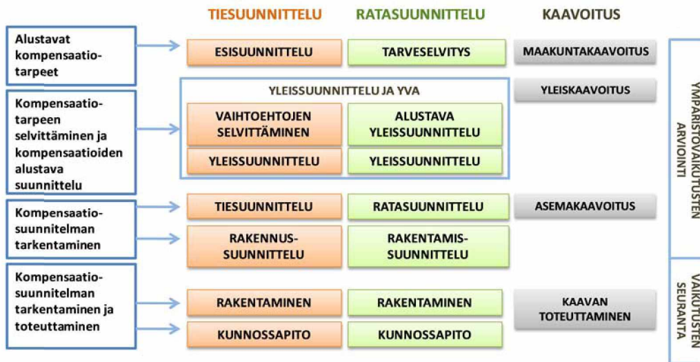
Kuva 11. Kompensatio osana suunnitteluprosessia. Kompensaatiotoimet saattavat lisäksi edellyttää kaavallista suunnittelua väyläalueen ulkopuolelle sijoituessaan.
