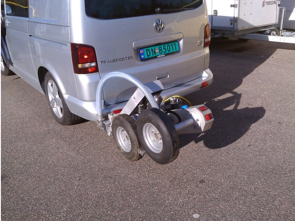
Kuva 8. TWO-kitkanmittauslaite. Kuva P.Virtala 2014.
