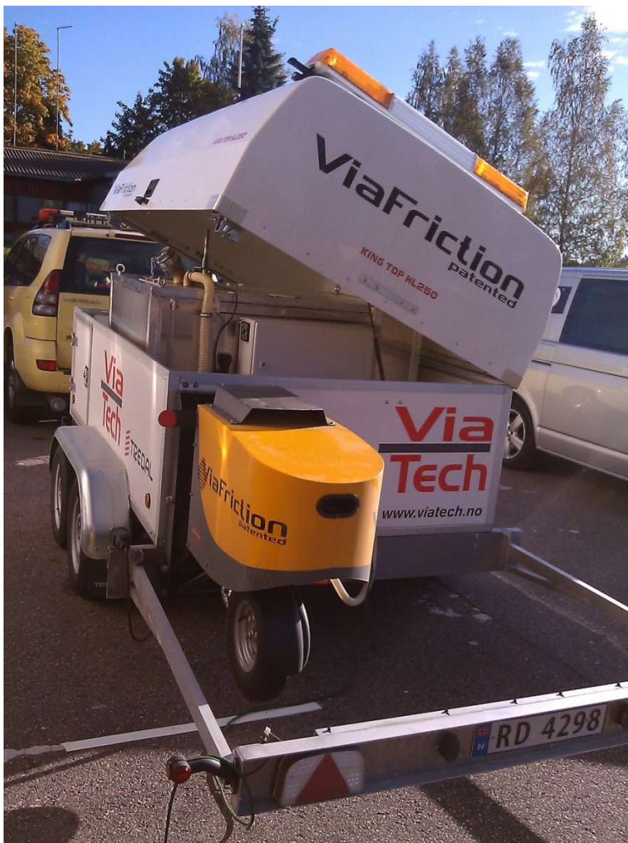
Kuva 6. Viatechin valmistama ViaFriction kitkanmittauslaite. Kuva P.Virtala 2014.
