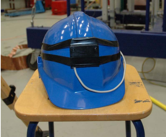
Kuva 26 Lisäanturin prototyypiversio kiinnitys kypärään testausta varten.
