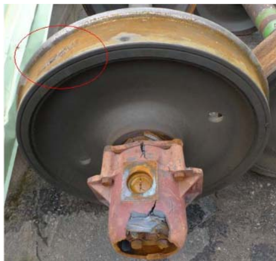
Kuva 2.18 Laakerivaurio, joka on aiheutunut pyörän vierintäpinnalla olevasta lovesta (Nurmentie 2010, s. 39).
