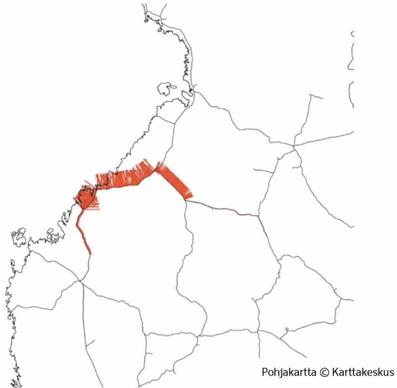
Kuva 11. Metsäenergian rautatiekuljetusvirrat Alholman laitokselle (GWh/vuosi) perusskenaarion mukaisessa valtakunnallisessa optimitilanteessa.
