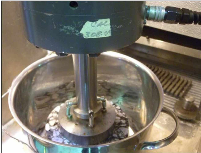
Kuva 4. Vesipaineiskunkestävyyden kuormituslaite (protoversio).
