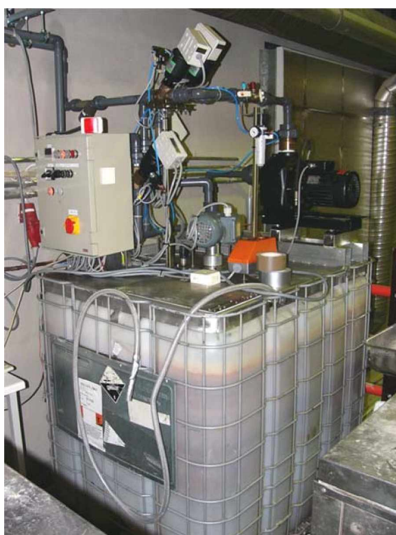
Kuva 58. Jäädytys-sulatuslaitteen ulkoinen vesisäiliö varusteineen.
