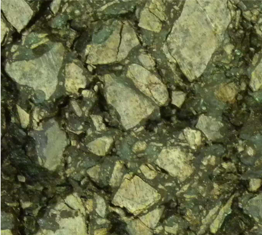
Kuva 42. Näytteen pinnassa rikkoutuneita kiviä vesipaineiskukokeen jälkeen ( T = +5\text{ °C} , p = 7000\text{ kPa} )
