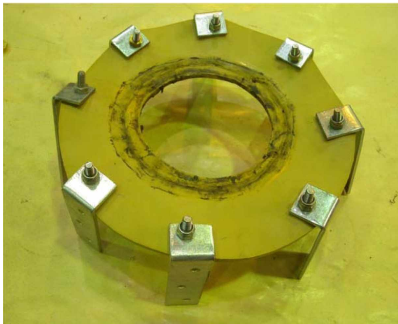
Kuva 5. Vesipaineiskukokeessa käytetty leveä kumitiiviste ja sen sivutuet.
