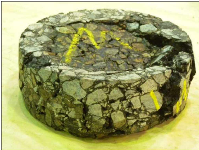
Kuva 45. Näyte murtumisen jälkeen lämpötilassa +5 °C ( p = 7000 \text{ kPa} , ei tiivistettä).
