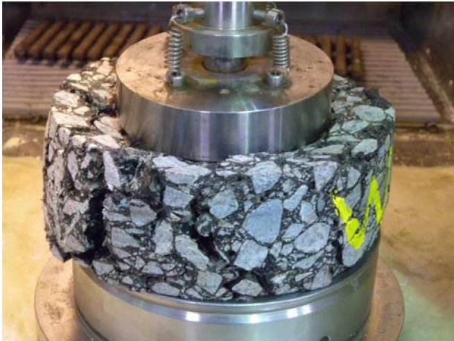
Kuva 44. Näyte vesipaineiskukokeen lopussa.
