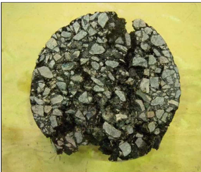
Kuva 46. Näytteen murtuminen tapahtui pintapaineilla 1000...2000 kPa mastiksia murtaen ( T +20 \text{ °C} , ilman tiivistettä).
