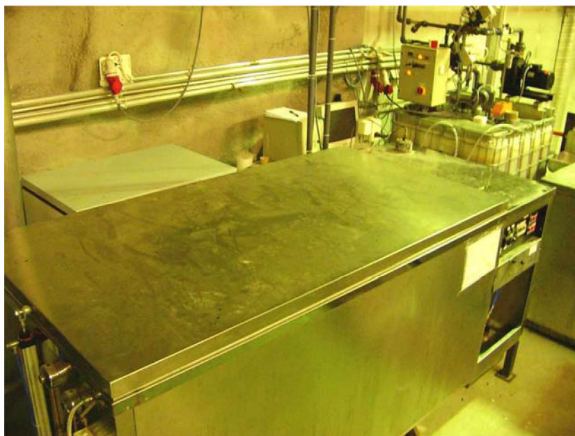
Kuva 57. Jäädytys-sulatuslaitteen näyteallas ja ohjausyksikkö. (syklien ohjaus automatiikalla PC:n avulla).
