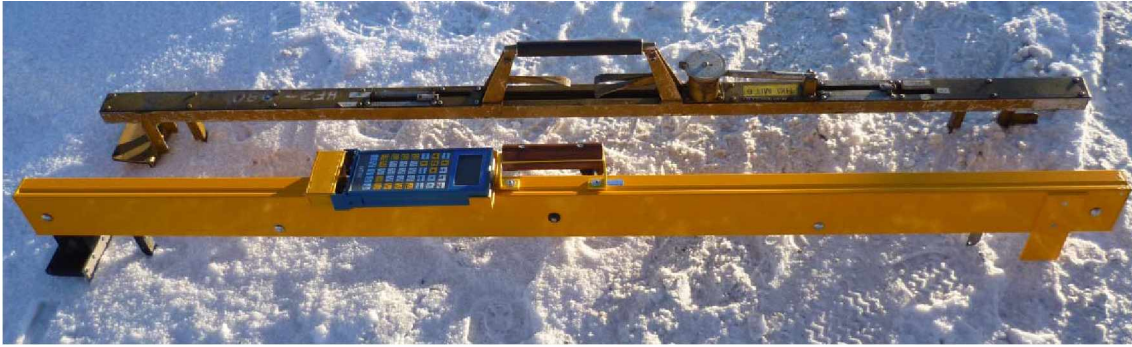
Kuva 14 Etualalla tyypillinen moderni kenttätietokoneellinen digitaalinen mittauslaite, takana vanhempi manuaalinen malli.
