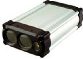
Kuva 5. Etäisyysmittari akselivälien mittaukseen.
