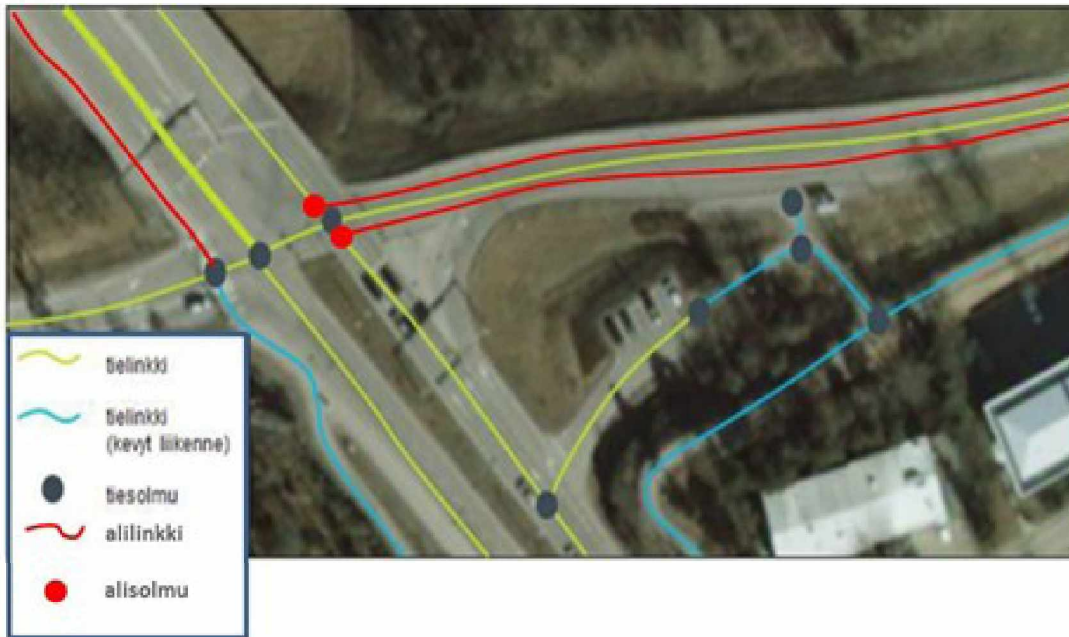
Kuva 2. Linkki-solmumallin havainnollinen tulkinta maastossa. Malli tukee myös tielinkki- ja tiesolmugeometriaa tarkemman geometrian esittämistä alilinkkien ja alisolmujen avulla.
