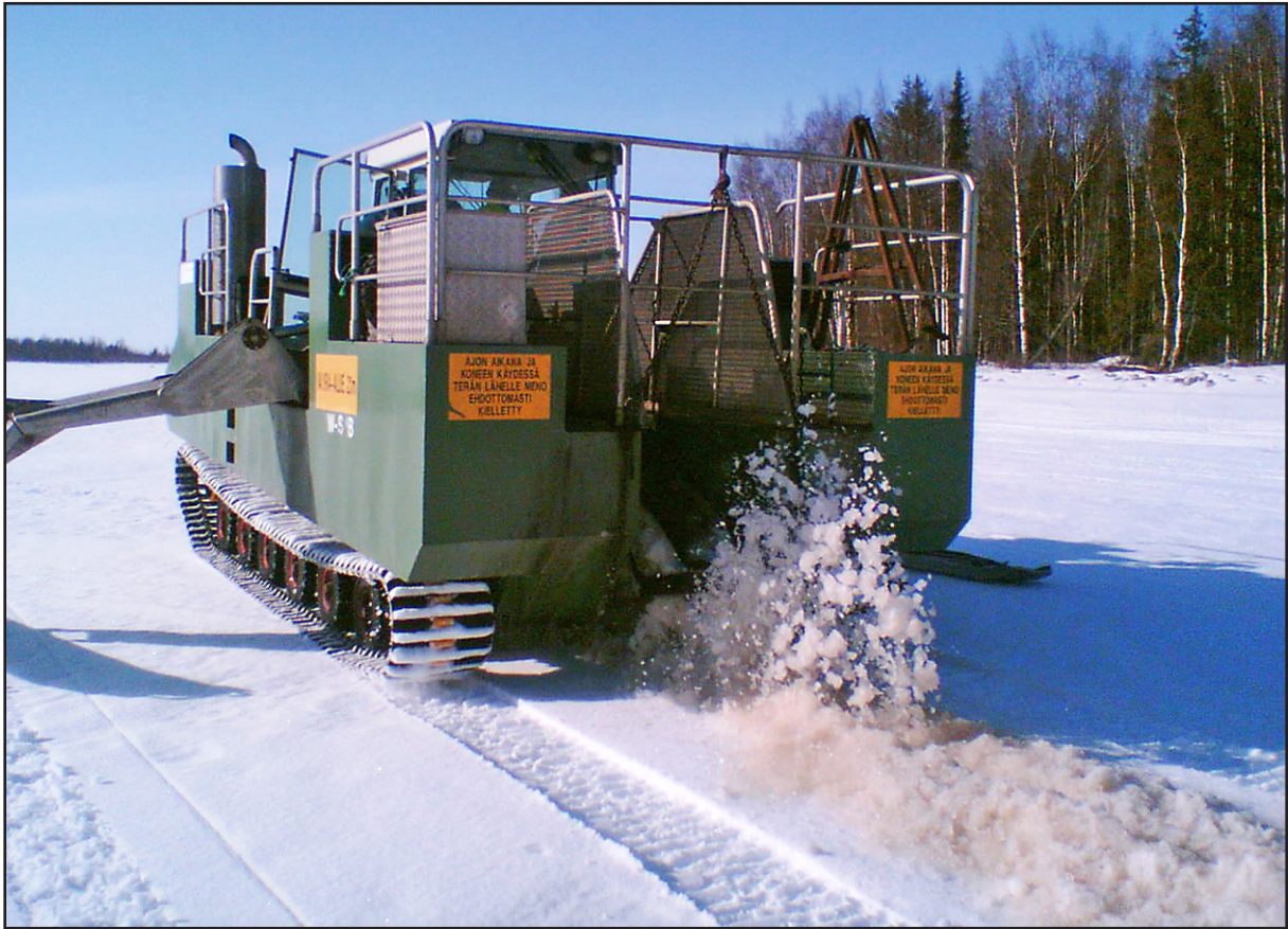
Kuva 10.8. ELY-keskuksen jääsaha (kuva Lapin ympäristökeskus)
