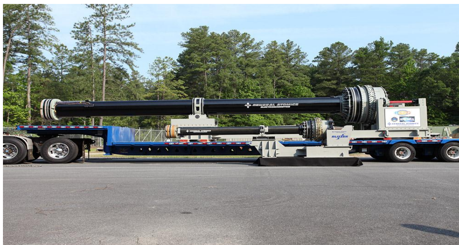
Kuva 3. General Atomics:in Blitzer 32 MJ ja 3 MJ raidetykit [11]
