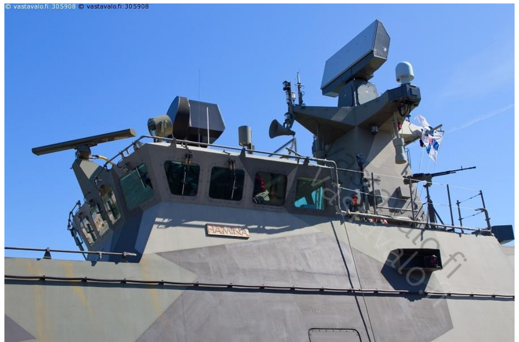
Kuva 9. Ohjusvene Hamina, ylipäätänsä 3d-tutkan antenni. [12]
