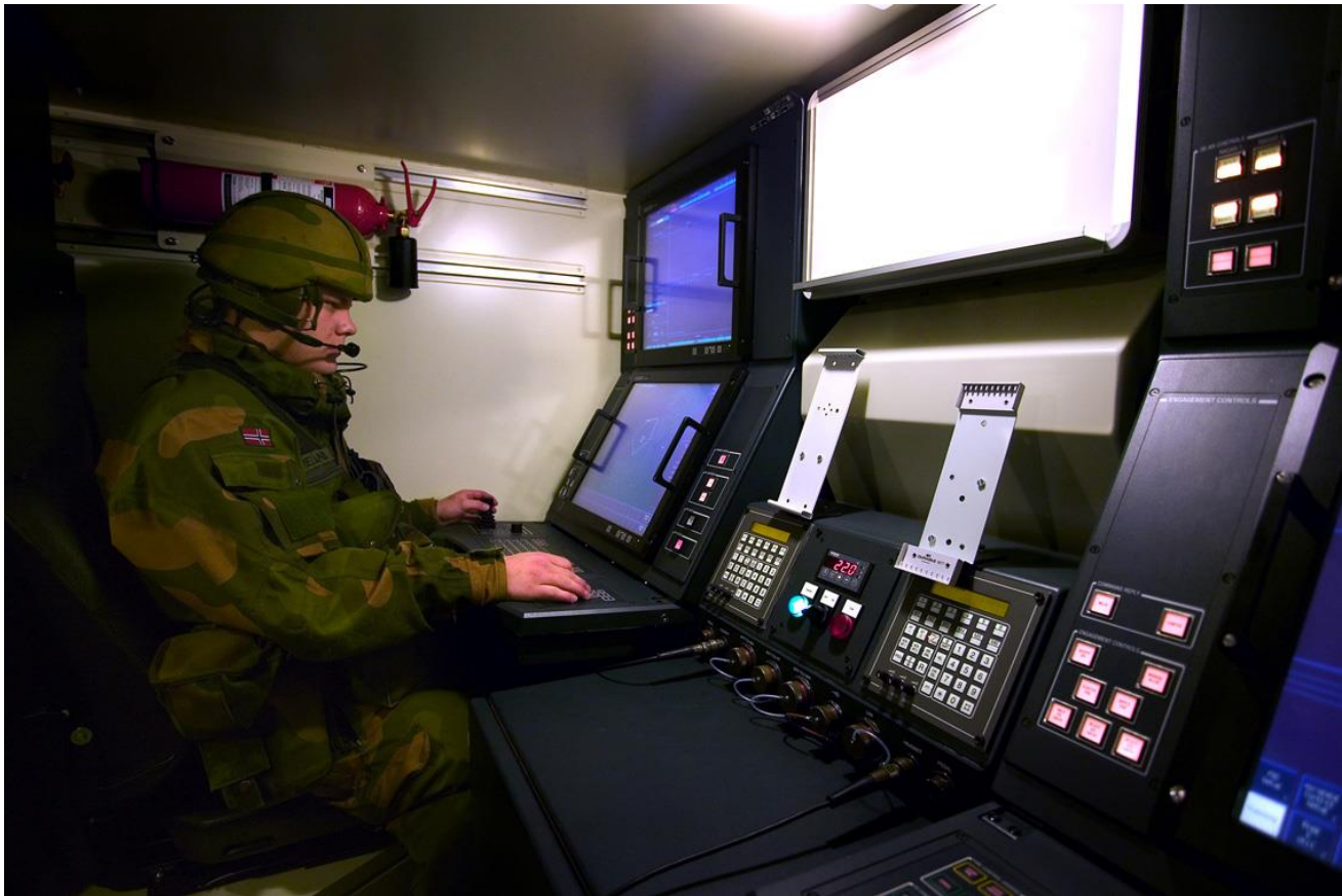
Kuva 2. ITO12 järjestelmän operaattori ja työpiste (FDC – Fire Distribution Center). [10]
