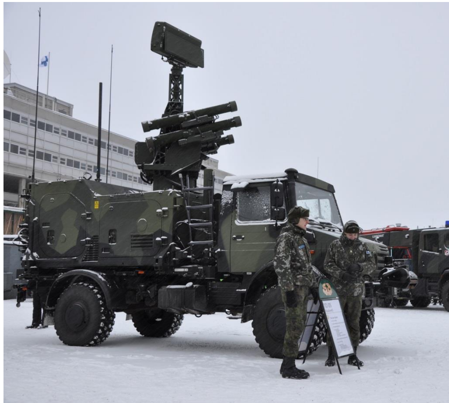
Kuva 8. ITO05 ilmatorjuntajärjestelmä, jossa maalinosoitustutka. [21]
