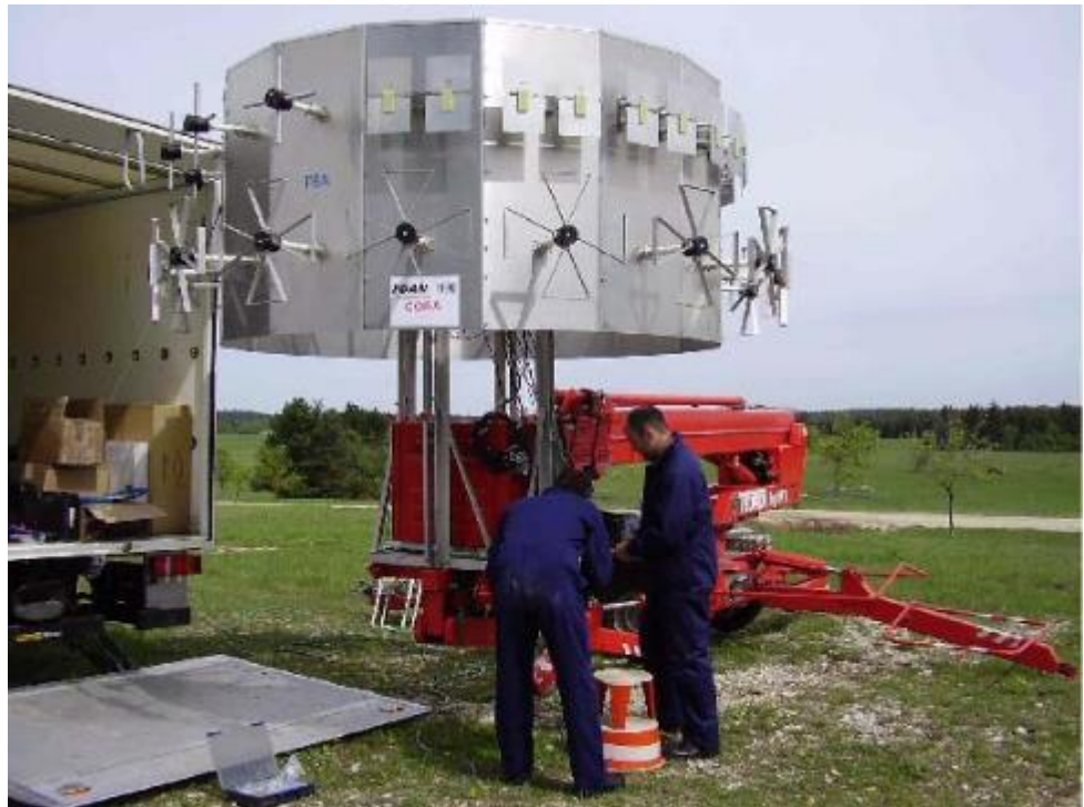
Kuva 10. Passiivinen tutka, jossa VHF- ja UHF-alueen antennit (2006).
